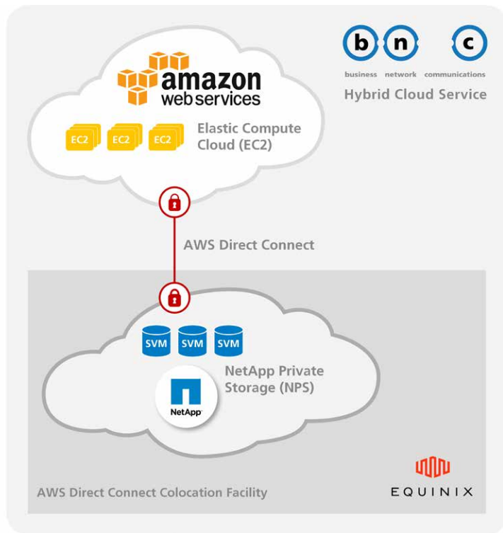
Abbildung: BNC Hybrid Cloud in Equinix Colocation Data Centern mit Verbindung zu Amazon Web Services (AWS)
